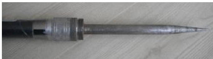
Колышек в походном состоянии, и на готовой к установке мачте. Детали колышка.
