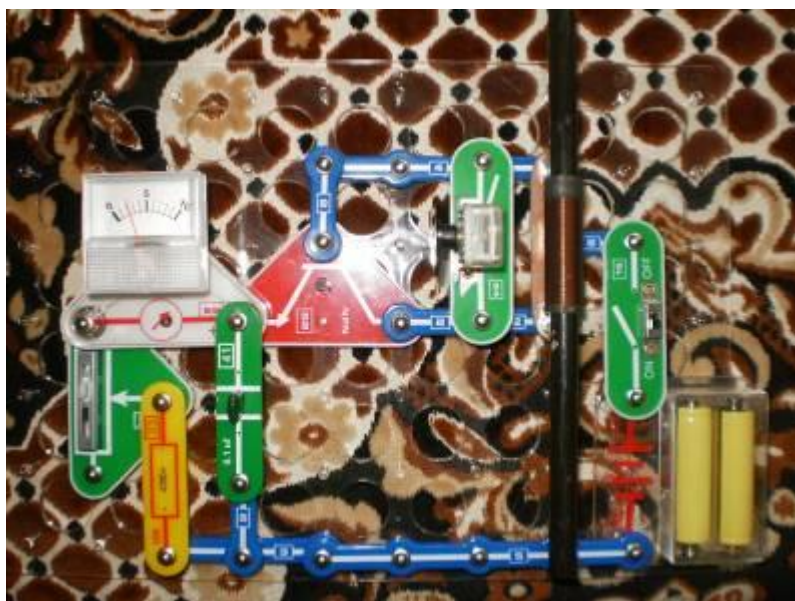
Рис. 07. Генератор в барьерном режиме – действующий CW передатчик.
