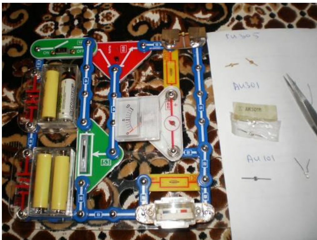
Рис. 06. Снимаем ВАХ двухполюсников с помощью регулируемого источника напряжения.
