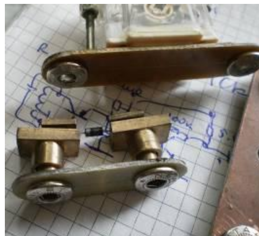
Рис. 05. Универсальный держатель для двухполюсников - всегда можно будет оперативно подключить любой элемент в схему, а также будем исследовать ВАХ интересных двухполюсников. Второй гальванометр в актив конструктора как раз для снятия ВАХ нам и понадобится.
