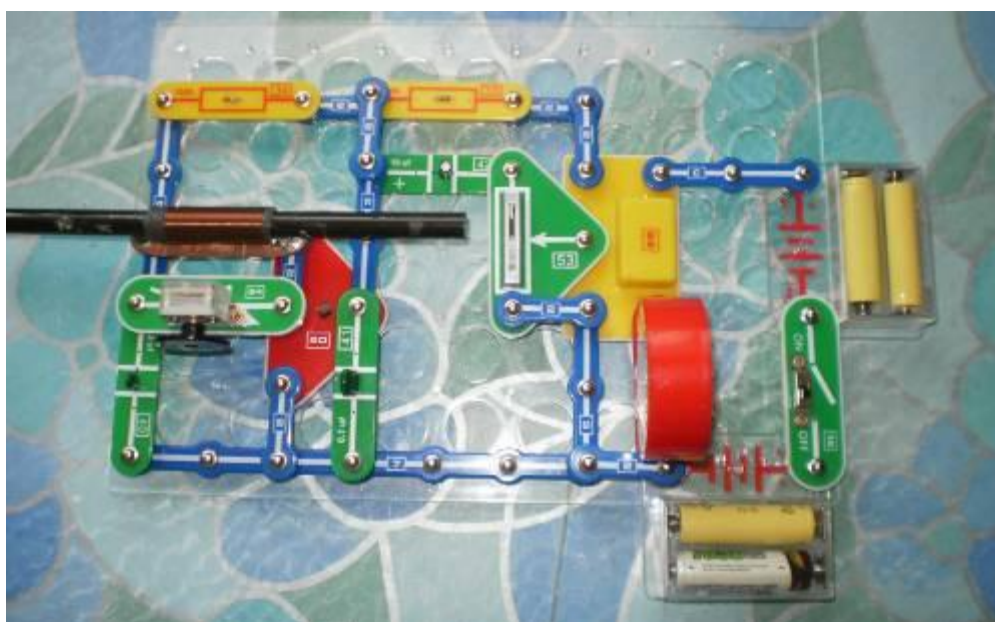
Рис. 02. Средневолновый приемник прямого усиления конструктора «Знаток» принимает не только помехи, но и NDB маяки.
