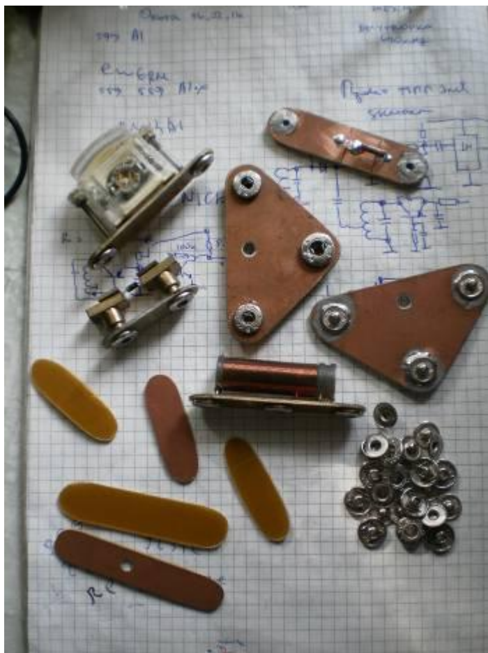
Рис. 05. Универсальный держатель для двухполюсников - всегда можно будет оперативно подключить любой элемент в схему, а также будем исследовать ВАХ интересных двухполюсников. Второй гальванометр в актив конструктора как раз для снятия ВАХ нам и понадобится.
