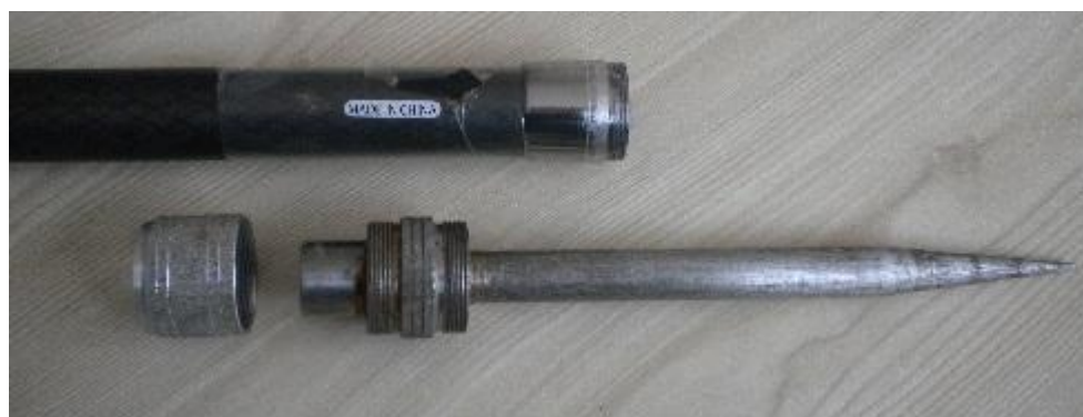
Колышек в походном состоянии, и на готовой к установке мачте. Детали колышка.
