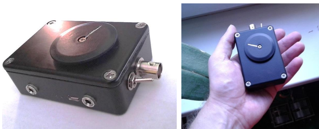
Рис. 3. Конструкция и внешний вид низковольтного трансивера.
