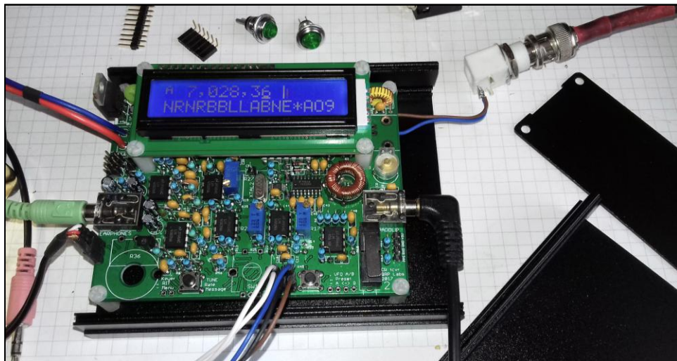
Obr. 1: Osazený transceiver (potenciometr a inkrementální snímač připojeny konektorem)
