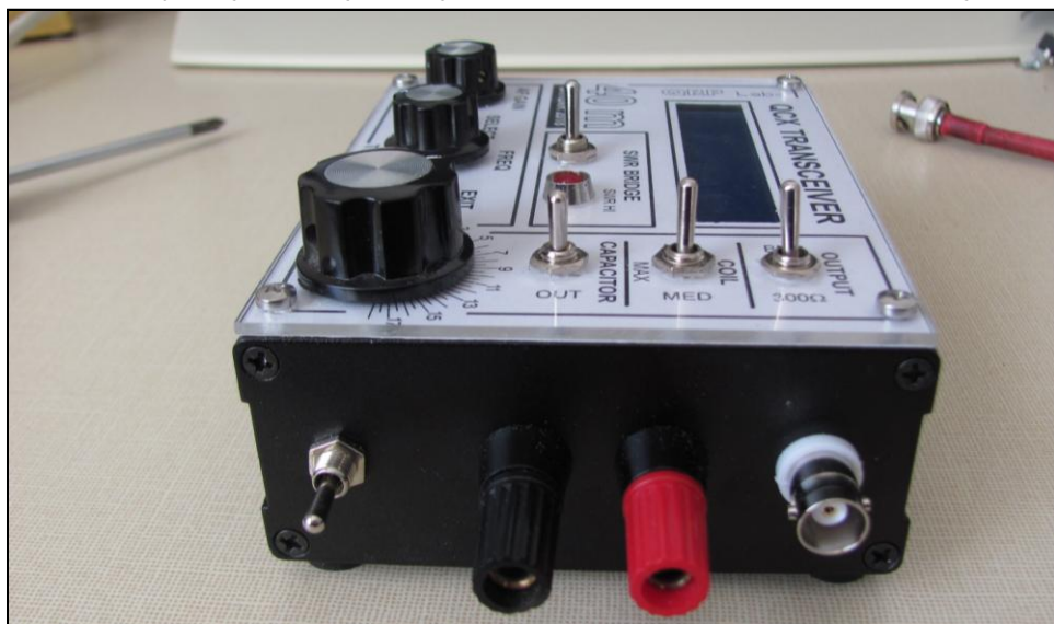
Obr. 8: Přepínač na bočním panelu zůstal nevyužit, ponechán jako rezerva.
