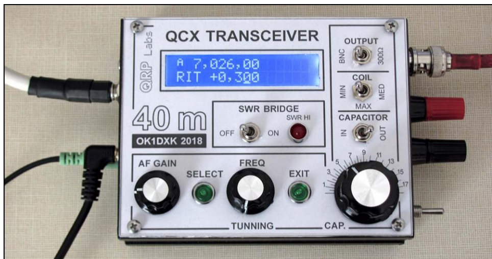
Obr 9: Zapnutý transceiver. Konektor pro klíč byl přetažený na levou stranu nad konektor pro sluchátka. Mohl by ale být namontován namísto nevyužitého přepínače vpravo.
