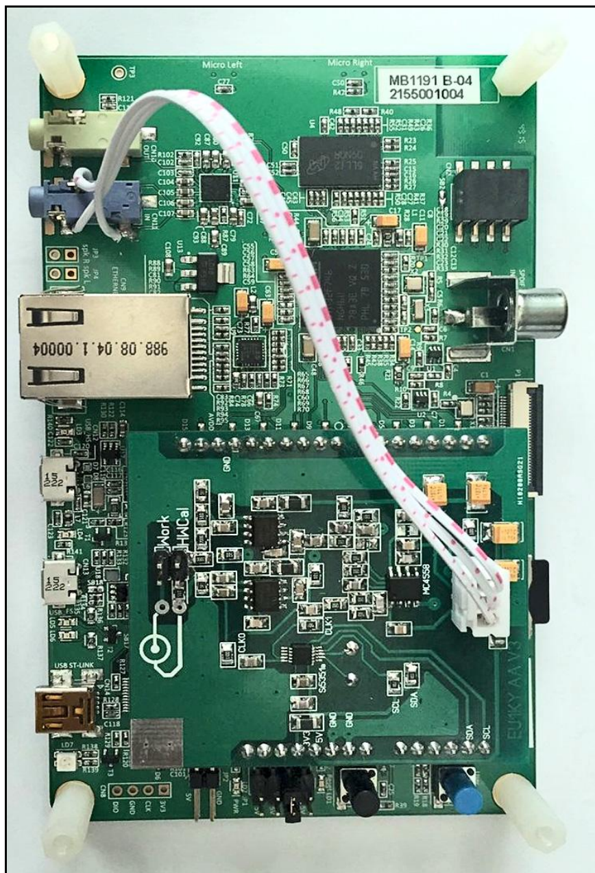
Obr. 2: zadní strana vývojové desky s měřicím modulem
