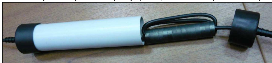
Obr. 7: Provedení tlumivky 3-30 MHz
